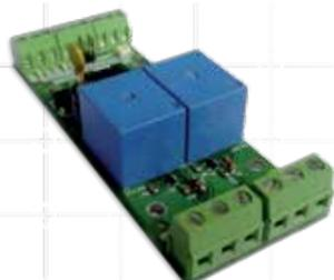
RU2 Modulo con 2 relè di uscita a 2A che rende stand-alone i lettori B100 e B100PROX-MF-SA. Alimentazione: 12/24 VDC - 15/24 VAC. Segnalazione sonora, uscita programmabile impulsiva temporizzata o bistabile. Collegamento in RS485 con B100.
