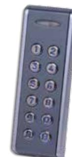
Tastiera slim stand-alone ed antivandalo. È possibile memorizzare fino a 99 diversi codici, da 1 a 8 cifre. Dispone di 1 uscita a relè (2A) e di 1 uscita a transistor, impostabili come impulsive, temporizzate (1- 99 sec) o bistabili. Idonea per fissaggio a parete e per installazioni all'esterno (IP67). Retroilluminata.
