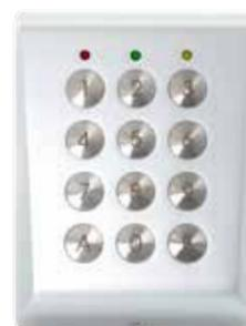
Tastiera antivandalo. È possibile memorizzare fino a 99 diversi codici, da 1 a 8 cifre. Dispone di 1 uscita a relè (2A) e di 1 uscita a transistor, impostabili come impulsive, temporizzate (1- 99 sec) o bistabili. Idonea per fissaggio a parete e per installazioni all'esterno (IP67).
