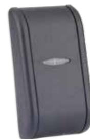
Letto di prossimità stand-alone 125 KHz; consente di memorizzare fino a 4.000 codici. Alimentazione 12/24 VAC/VDC. Idoneo per installazioni all'esterno (IP66).
