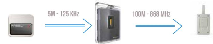
I lettori **Free 15R** art. 210-532, **Free 30R** art. 210-533 e **Free 50R** art. 210-541 si interfacciano invece con tag attivi (Free 15T e Free TH) e raggiungono rispettivamente distanze di lettura di 1,5 mt, 3 mt e 5 mt. Possono essere utilizzati in modalità stand-alone oppure collegati ad una centralina APICE.
