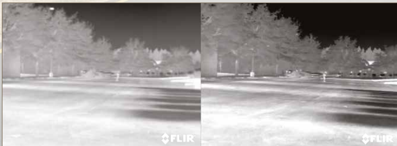
L'immagine con risoluzione 320x240 pixel, a sinistra, mostra un dettaglio molto inferiore rispetto all'immagine con risoluzione di 640x480 pixel, a destra.
